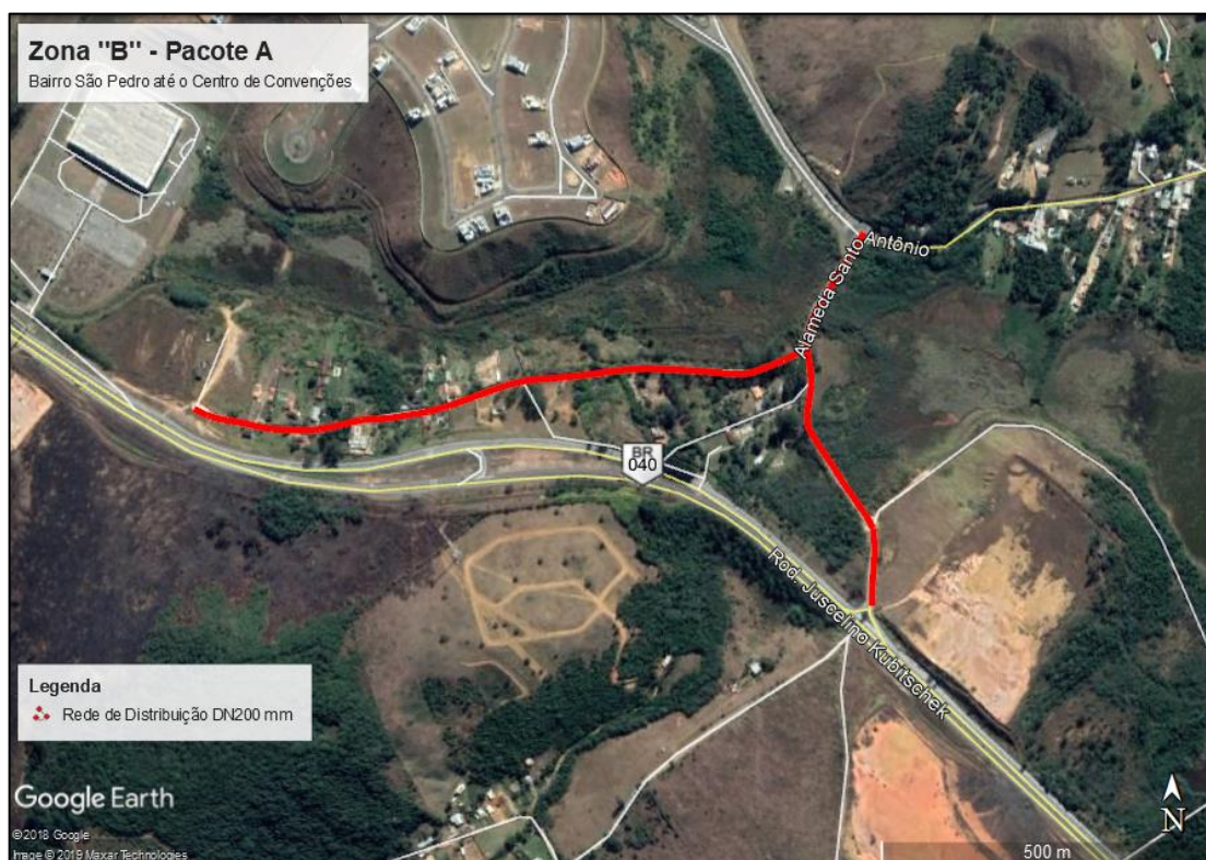
Figura 18: Rede de Distribuição de Água na Zona "B" – Bairro São Pedro até o Centro de Convenções – Pacote A.
