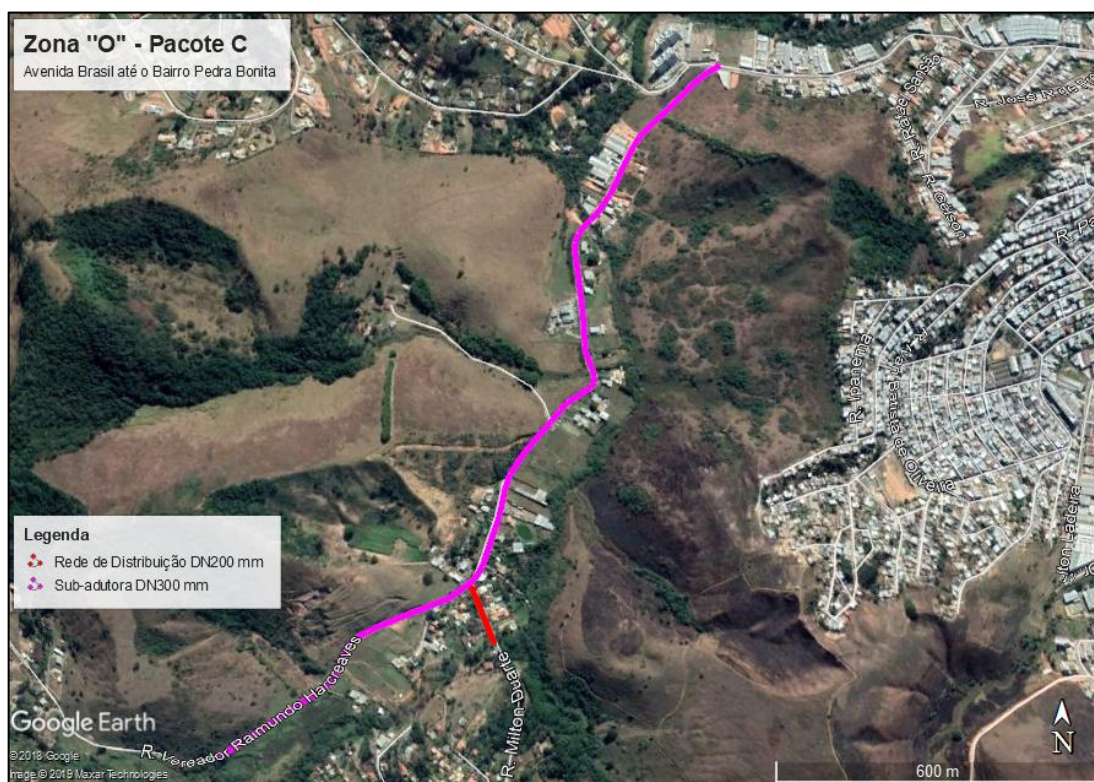
Figura 14: Sub-adutora e rede de distribuição de água na Zona "O" – Avenida Brasil até o Bairro Pedra Bonita – Pacote C.
