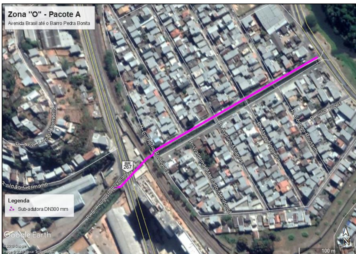
Figura 7: Sub-adutora de Água na Zona "O" – Avenida Brasil até o Bairro Pedra Bonita – Pacote A.
