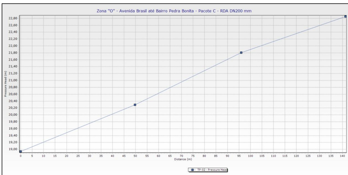
Figura 17: Pressões – Rede de Distribuição de Água na Zona "O" – Avenida Brasil até o Bairro Pedra Bonita – Pacote C. Fonte: WaterGEMS, 2019.
